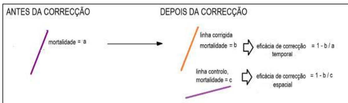
Figura 2 – Esquema representativo da avaliação da eficácia de troços por comparação temporal ou espacial.
