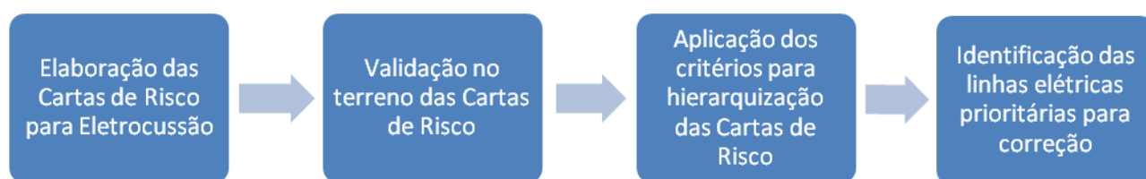
Figura 6 – Esquematização dos Critérios de Aplicação das Cartas de Risco de eletrocussão
