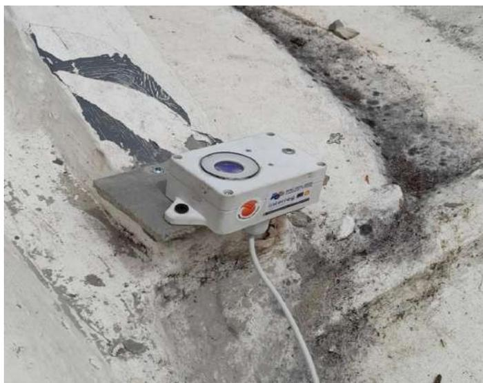
*Figura\_2 - Fotómetro de medição de escuridão noturna.*
