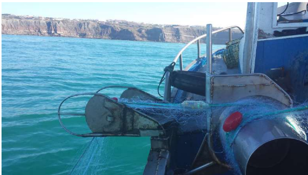
Figura 10_ Luzes sinalizadoras de luz verde na rede experimental durante a alagem © Nuno Oliveira
