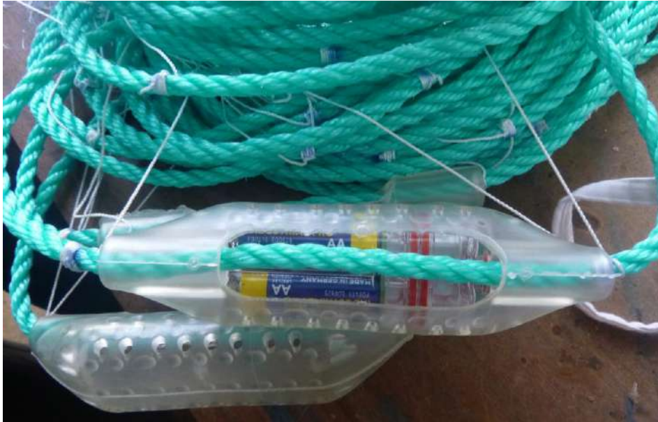
Figura 9_ Luzes sinalizadores dentro do invólucro, colocadas na linha madre de rede de emalhar. © Elisabete Silva
